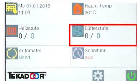
Durch Tippen auf Symbol %- Anzeige wird die Anlage stufenlos betrieben.
