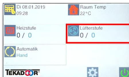
Durch Tippen auf Symbol % wird die Anlage stufenlos betrieben.
